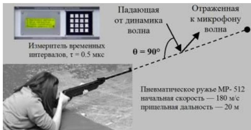
Рис. 6. Эксперимент по измерению поперечного Доплер-эффекта
