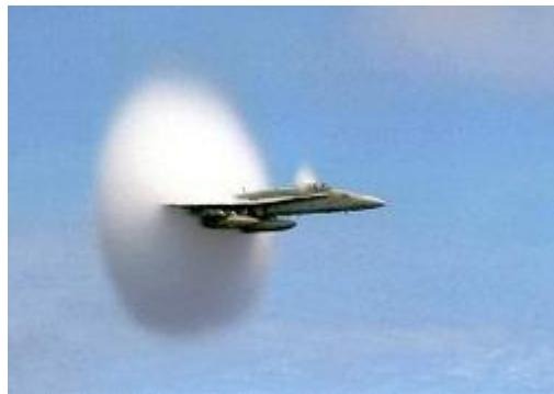
**Рис. 5.** Фотография реактивного самолета FA-18, летящего быстрее звука. Вблизи летательного аппарата виден светлый конус ударной волны. Дело в том, что сразу же за конусом создается зона пониженного давления, в которой происходит мгновенная конденсация паров влаги. В 1911 году Э. Мах установил, что угол  $\theta$  при вершине конуса ударной волны всецело определяется относительной скоростью  $\beta$ , поэтому параметр  $\beta$  часто называют *числом Maxa*.
