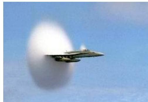
**Рис. 3б.** Фотография самолета FA-18, на которой тоже виден конус ударной волны.
