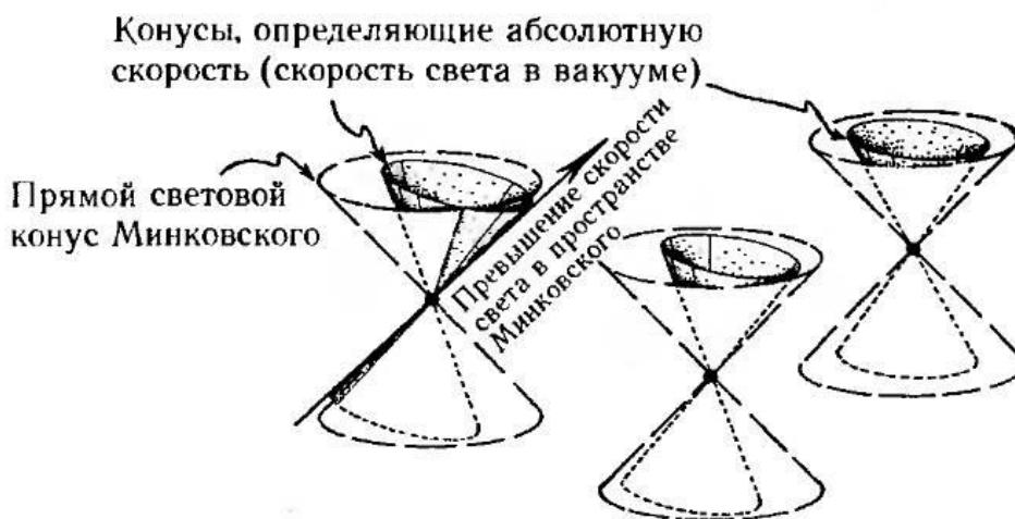
Рис. 4.4. Распространение света согласно общей теории относительности Эйнштейна не может являться эффектом «преломляющей среды» (в пространстве Минковского), поскольку это противоречит фундаментальному принципу специальной теории относительности – невозможности распространения сигналов со скоростью, превышающей скорость света в пространстве Минковского.
