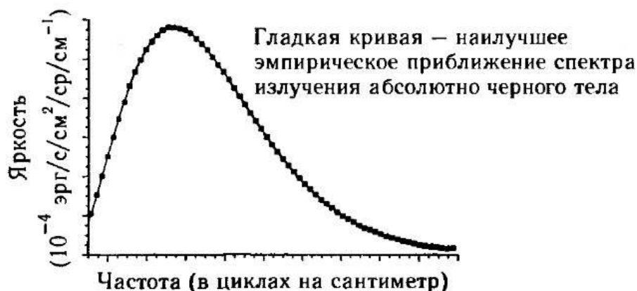
Рис. 4.12. Точное согласие между результатами наблюдений, полученными со спутника COBE, и теоретическими результатами в предположении «тепловой» природы излучения Большого Взрыва.
